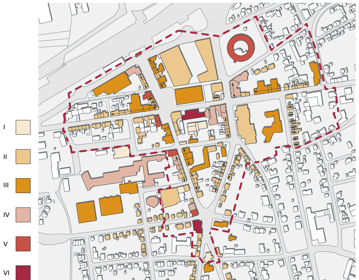
Abb.18: Strukturplan mit Eintragung der Geschossigkeiten nach Bestandsaufnahme (Quelle: planquadrat)
